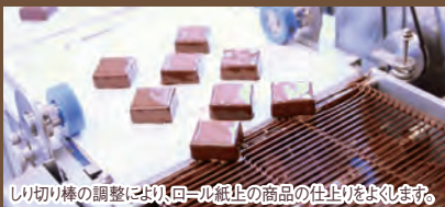
しり切り棒の調整により、均一な商品の仕上がりを実現します。
