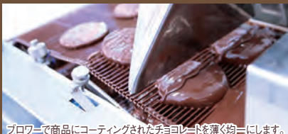
ブローアで商品にコーティングされたチョコレートを薄く均一にします。
