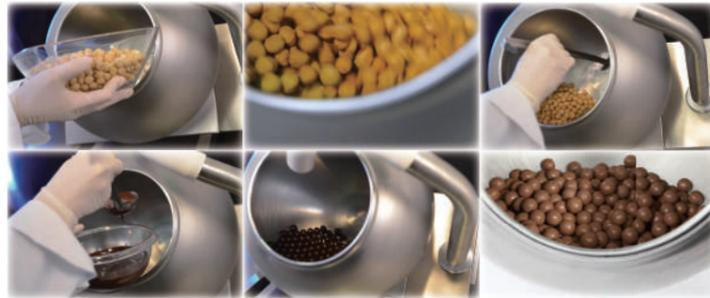
ナッツやドライフルーツなどの素材へ均一にチョコレート进行コーティングすることができます。チョコレートを冷やす送風機能付きで、手作りで要する製造時間を大幅に短縮させることができます。回転スピードも細かく調節でき、使用するチョコレートやコーティングする素材によって使い分けることができます。
